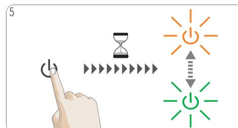
5 EIN/AUS-Symbol drücken und mindestens 5 Sekunden gedrückt halten. Das EIN/AUS-Symbol beginnt abwechselnd grün und orange zu blinken und die Maschine wechselt in den Entkalkungsmodus.
