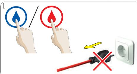
1 Maschine nicht kippen oder auf den Kopf stellen! Um die Zubereitung zu unterbrechen, Heiß-/Kaltwassersymbol erneut antippen. Netzstecker nicht aus der Steckdose ziehen! Die Maschine baut den Druck ab.
