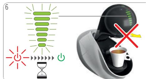
6 Nach Abschluss der Zubereitung blinken die Leuchtbalkeanzeige und das EIN/AUS-Symbol (rot) ca. 5 Sekunden. **Währenddessen darf der Kapselhalter nicht entfernt werden!**
