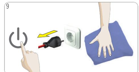
Maschine ausschalten. Maschine ausstecken! Maschine mit einem weichen, feuchten Tuch reinigen. Anschließend mit einem weichen Tuch trocknen.
