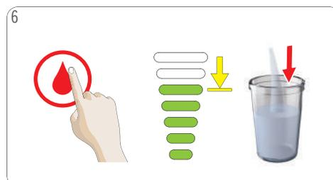
6 Heißwassersymbol antippen. Die Leucht balken erlöschen der Reihe nach. Der Entkalkungsvorgang dauert ca. 2 Minuten. Dabei startet und stoppt die Maschine mehrfach. Abwarten, bis die Maschine stoppt.
