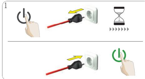
Maschine ausschalten. Überprüfen, ob die Kapsel blockiert ist (siehe 9.2 „WENN KEINE FLÜSSIGKEIT HERAUSFLIESST – KAPSEL / DÜSE BLOCKIERT“ auf Seite 16). Netzstecker ausstecken und 20 Minuten warten. Netzstecker wieder in die Steckdose stecken und Maschine einschalten.
