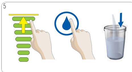
Zuerst mit kaltem Wasser spülen. Leuchtbalkeanzeige durch Berührung mit dem Finger auf Maximum stellen. Kaltwassersymbol antippen. Die Maschine beginnt zu spülen. Die Leuchtbalke erlöschen der Reihe nach.
