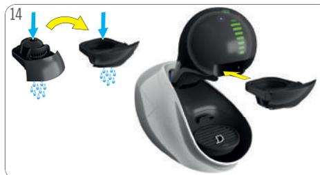
Kapselhalter auf beiden Seiten mit Wasser abspülen. Kapselhalter abtrocknen. Kapselhalter wieder in die Maschine einführen. Genießen Sie Ihr Getränk!
