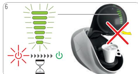
6 Nach Abschluss der Zubereitung blinken die Leuchtbalkenanzeige und das EIN/AUS-Symbol (rot) ca. 5 Sekunden. **Währenddessen darf der Arretierungsbügel nicht geöffnet werden!**
