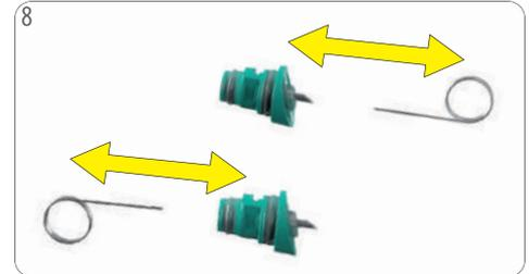
8 Reinigungsnadel in die Düse einführen und Düse reinigen. Sollte das nicht möglich sein, mit dem Inhalt eines Entkalkerbeutels und 0,5 Liter frischem Trinkwasser Entkalkertlösung herstellen. Düse in Entkalkertlösung legen.
