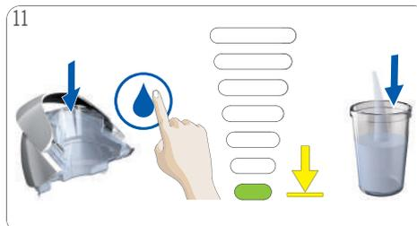
11 Wasserbehälter mit frischem Trinkwasser füllen. Kaltwassersymbol antippen. Die Leucht balken erlöschen der Reihe nach. Abwarten, bis die Maschine stoppt.
