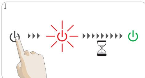
1 Prüfen, ob der Wasserbehälter ausreichend frisches Trinkwasser enthält. Maschine einschalten. Während die Maschine aufheizt, blinkt das EIN/AUS-Symbol rot. Nach ca. 30 Sekunden leuchtet das EIN/AUS-Symbol grün. Die Maschine ist bereit.
