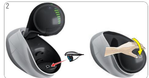
Prüfen, ob Abtropfschale in der niedrigsten Position eingesetzt wurde. Maschine manuell schließen.
