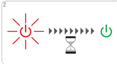
Während die Maschine aufheizt, blinkt das EIN/AUS-Symbol rot. Nach ca. 30 Sekunden leuchtet das EIN/AUS-Symbol grün. Die Maschine ist bereit.
