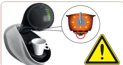
Es fließt keine Flüssigkeit heraus: Die Kapsel könnte blockiert sein und unter Druck stehen.
