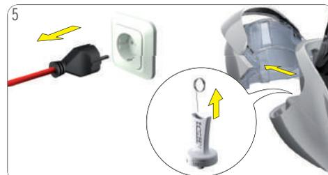
5 Maschine ausstecken! Wasserbehälter entfernen. Düse-Werkzeug herausnehmen. Reinigungsnadel aus dem Düse-Werkzeug herausziehen. Nadel darf nicht in die Hände von Kindern gelangen!
