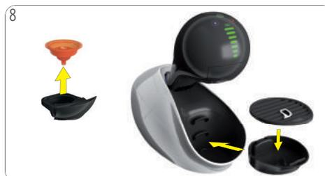
Kapselhalter herausziehen. Spüleinsatz entfernen. Kapselhalter wieder einsetzen. Abtropfgitter auf die Abtropfschale legen. Abtropfschale in der gewünschten Position an der Maschine anbringen. Wasserbehälter ggf. entleeren.
