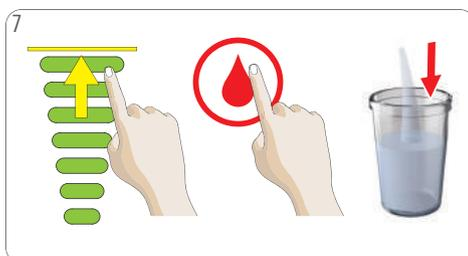
Dann mit heißem Wasser spülen: Leuchtbalkeanzeige durch Berührung mit dem Finger auf Maximum stellen. Heißwassersymbol antippen. Die Maschine beginnt zu spülen. Die Leuchtbalke erlöschen der Reihe nach.
