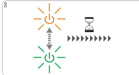
8 Damit die Entkalkerlösung besser wirken kann, wartet die Maschine zunächst 2 Minuten ab. Während dieser Zeit blinkt das EIN/AUS-Symbol abwechselnd grün und orange.
