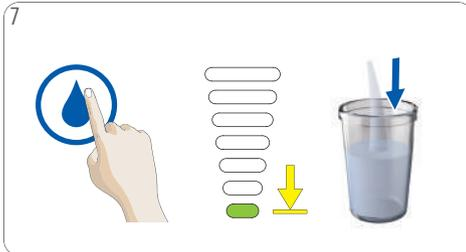
7 Kaltwassersymbol antippen. Die Leucht balken erlöschen der Reihe nach. Der Entkalkungsvorgang dauert ca. 2 Minuten, bis der Wasserbehälter leer ist. Abwarten, bis die Maschine stoppt.
