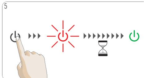
Maschine einschalten. Während die Maschine aufheizt, blinkt das EIN/AUS-Symbol rot. Nach ca. 30 Sekunden leuchtet das EIN/AUS-Symbol grün. Die Maschine ist bereit.
