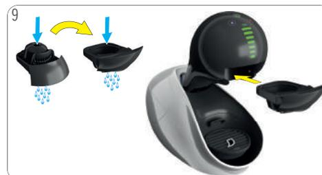
9 Kapselhalter auf beiden Seiten mit Wasser abspülen. Kapselhalter abtrocknen. Kapselhalter wieder in die Maschine einführen. Genießen Sie Ihr Getränk!
