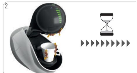
2 Das Getränk spritzt oben aus dem Kapselhalter heraus. Abwarten, bis der Vorgang beendet ist. Sie erkennen dies daran, dass die Maschine keine Geräusche mehr macht.
