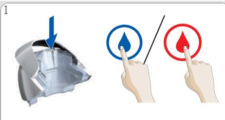
1 Prüfen, ob der Wasserbehälter ausreichend frisches Trinkwasserenthält. Wenn nicht, dann Wasserbehälter mit frischem Trinkwasser auffüllen und Heiß-/Kaltwassersymbol erneut antippen, um mit der Zubereitung fortzufahren. Wenn der Wasserbehälter voll ist, wie im Folgenden beschrieben vorgehen.
