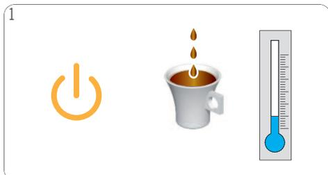
1 Wenn das Getränk langsamer als üblich herausläuft (evtl. sogar nur tropfenweise) oder kühler als üblich ist oder der Netzschalter kontinuierlich orange leuchtet (Entkalkungsanzeige), muss die Maschine entkalkt werden.
