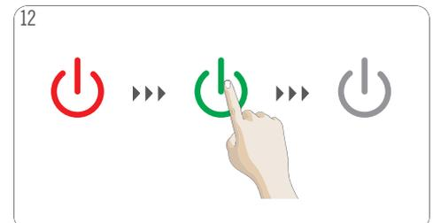
12 Am Ende des Spülvorgangs leuchtet das EIN/AUS-Symbol rot. Warten, bis der Netzschalter grün leuchtet. Behälter entfernen. Maschine ausschalten.
