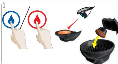
Zum Beenden der Zubereitung, aktives Heiß- bzw. Kaltwassersymbol antippen. Kapselhalter herausziehen. Kapsel überprüfen. Kapsel wegwerfen.
