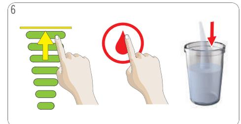
Maschine spülen: Balkenanzeige mit dem Dosierungsschieber auf Maximum stellen. Heißwassersymbol antippen. Die Maschine beginnt zu spülen. Die Leucht balken erlöschen der Reihe nach.
