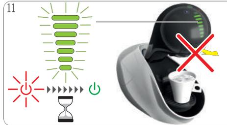
Nach Abschluss der Zubereitung blinken die Leuchtbalkenanzeige und das EIN/AUS-Symbol (rot) ca. 5 Sekunden. **Währenddessen darf der Kapselhalter nicht entfernt werden!**
