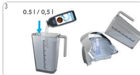
3 0,5 Liter frisches Trinkwasser in einem Messbecher mit dem Inhalt des Entkalkerbeutels vermischen. Entkalkerlösung in den Wasserbehälter gießen und Wasserbehälter auf die Maschine stellen.
