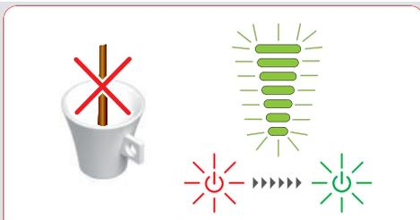
Es fließt keine Flüssigkeit heraus: Die Getränkezubereitung wird während des Vorgangs unterbrochen oder beginnt erst gar nicht. Die Leuchtbalkenanzeige blinkt, und das Symbol für EIN/AUS blinkt rasch abwechselnd rot und grün.
