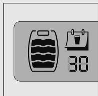
Wenn Sie ein neues, volles Keg einlegen, wird dies von dem Gerät automatisch registriert. Auf der Anzeige erscheinen 4 Volumenstufen sowie 30 Tage im Kalenderbereich.
