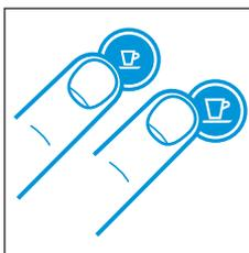
5. Um den Entkalkungsvorgang zu starten, drücken Sie im Bereit Modus 3 Sekunden lang gleichzeitig die Espresso- und Lungotaste.
