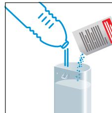
3. Füllen Sie den Wassertank mit einem Beutel der Nespresso Entkalkungslösung und 0,5 L Leitungswasser auf.
