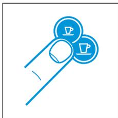
5. Pulse el botón Espresso (40 ml) o Lungo (110 ml) para empezar. La preparación se detendrá de forma automática. Para detener la salida del café o rellenar su taza, pulse de nuevo.
