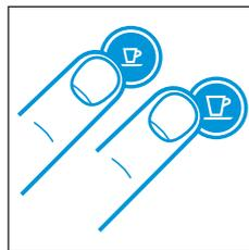
Als u de machine wilt uitschakelen voordat deze automatisch wordt uitgeschakeld, drukt u de knoppen Espresso en Lungo tegelijk in.
