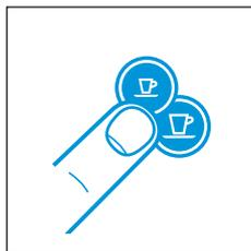
2. Druk op de knop Espresso of Lungo om de machine in te schakelen.
