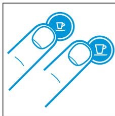
Um die Maschine auszutauschen, bevor sie in den automatischen Power-off Modus wechselt, drücken Sie die Espresso- und die Lungotaste gleichzeitig.
