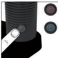
3. Tegye a fedőt az Aeroccino-ra. Forró ital készítéséhez röviden nyomja meg a gombot. A gomb pirosan világít. Szükséges idő: körülbelül 70–80 másodperc. Hideg tejhabhoz nyomja le a gombot körülbelül 2 másodpercig. A gomb kéken világít. Szükséges idő: körülbelül 60 másodperc.
