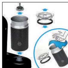
4. Myć części po każdym użyciu. Opłukać i przetrzeć wilgotną ściereczką. Nie stosować szczotek. Dzbane jest wodoodporny ale nie może być myty w zmywarce.
