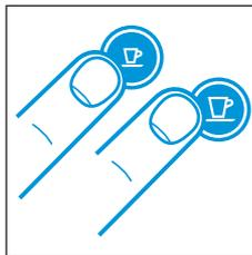
Para apagar la máquina antes de que se apague automáticamente, pulse los botones Espresso y Lungo simultáneamente.
