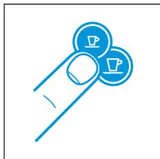
Um die Maschine einzuschalten, drücken Sie die Espresso- oder Lungotaste.
