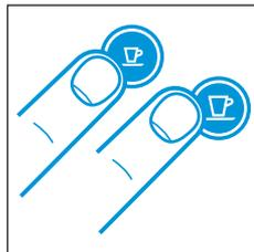
10. Um den Entkalkungsmodus zu verlassen, drücken Sie gleichzeitig die Espresso- und die Lungotaste für 3 Sekunden.
