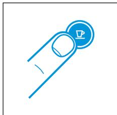
3. Ennek megváltoztatásához nyomja meg az Espresso gombot: Egyszer a 9 perc utáni kikapcsolt állapothoz. Még egyszer a 30 perc utáni kikapcsolt állapothoz.
