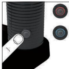
3. Coloque la tapa sobre el Aeroccino. Para una preparación caliente, pulse brevemente el botón de encendido. El botón se ilumina en rojo. Tarda aproximadamente entre 70 y 80 s. Si desea obtener espuma de leche fría, mantenga pulsado el botón durante aproximadamente 2 s. El botón se ilumina en azul. Tarda aproximadamente 60 s.
