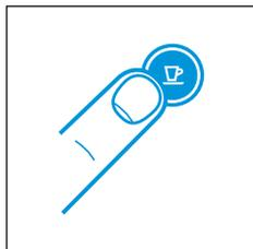
3. Para cambiar este ajuste, pulse el botón Espresso: Una vez para activar el modo de apagado automático tras 9 minutos de inactividad. Otra vez para activar el modo de apagado automático tras 30 minutos de inactividad.
