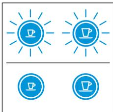
3. Anschließend blinken die Tasten in der Aufheizphase, bis die Maschine betriebsbereit ist.
