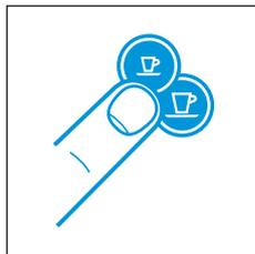
5. Druk op de knop Espresso (40 ml) of Lungo (110 ml) om de machine in te schakelen. Na extractie stopt de machine automatisch. Druk nogmaals om de doorstroming van de koffie te stoppen of er koffie aan toe te voegen.
