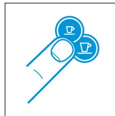
5. Drücken Sie die Espresso- oder Lungotaste, um die Maschine einzuschalten.
