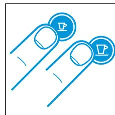
3. Pulse los botones Espresso y Lungo simultáneamente durante 3 segundos.
