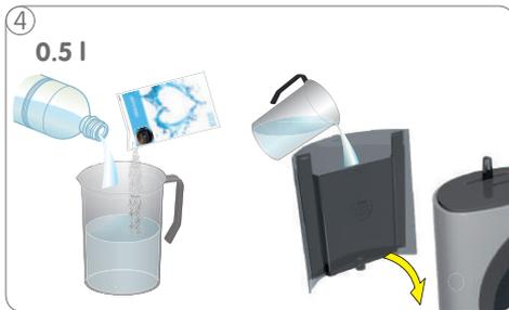
4 0.5 l 0.5 Liter frisches Trinkwasser in einem Messbecher mit dem Inhalt des Entkalkerbeutels vermischen. Entkalkerlösung in den Wasserbehälter gießen und Wasserbehälter auf die Maschine stellen.
