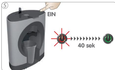
5 Maschine einschalten. Während die Maschine ca. 40 Sekunden lang aufheizt, blinkt der Netzschalter rot. Anschließend leuchtet der Netzschalter grün. Die Maschine ist bereit.
