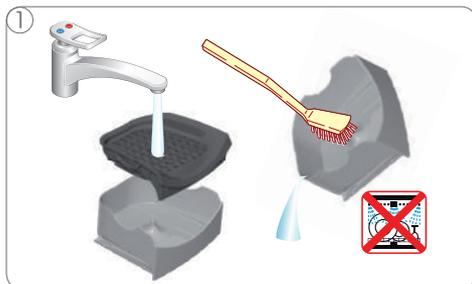
1 Abtropfschale mit Wasser abspülen und mit einer Bürste reinigen. Teile nicht in der Spülmaschine reinigen.
