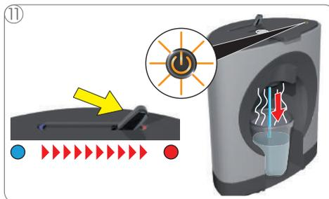
11 Wahlhebel in die Position "HEISS" bringen. Die Maschine beginnt zu spülen. Der Netzschalter blinkt orange.
