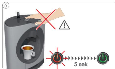
6 Nach Abschluss der Zubereitung blinkt der Netzschalter ca. 5 Sekunden rot. **Währenddessen darf der Arretierungsbügel nicht geöffnet werden!**
