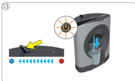
13 Wahlhebel in die Position "KALT" bringen. Die Maschine beginnt zu spülen. Der Netzschalter blinkt orange.
