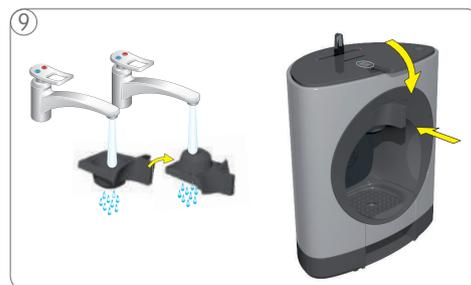
9 Kapselhalter auf beiden Seiten mit Wasser abspülen und abtrocknen. Kapselhalter in die Maschine einführen. Genießen Sie Ihr Getränk!
