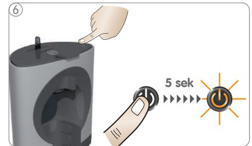
6 Netzschalter mindestens 5 Sekunden gedrückt halten. Der Netzschalter beginnt orange zu blinken und die Maschine wechselt in den Entkalkungsmodus.
