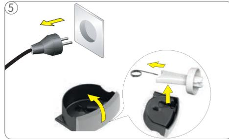
Maschine ausstecken! Abtropfschale herumdrehen. Düse-Werkzeug herausnehmen. Reinigungsnadel aus dem Düse-Werkzeug herausziehen. **Reinigungsnadel darf nicht in die Hände von Kindern gelangen!**
