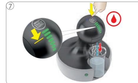
Heißwassersymbol antippen. Die Leuchtbalkenanzeige zeigt an, wie viel Zeit verbleibt. Der Entkalkungsvorgang dauert ca. 2 Minuten. Dabei startet und stoppt die Maschine mehrfach. Abwarten, bis die Maschine stoppt.
