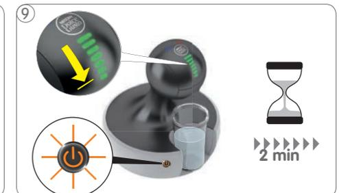
Damit die Entkalkerlösung besser wirken kann, wartet die Maschine zunächst 2 Minuten ab. Während dieser Zeit blinkt der Netzschalter abwechselnd grün und orange.
