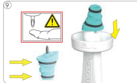
Überprüfen, ob beide O-Ringe intakt sind und korrekt auf der Düse sitzen. Düse auf das Düse-Werkzeug setzen.
