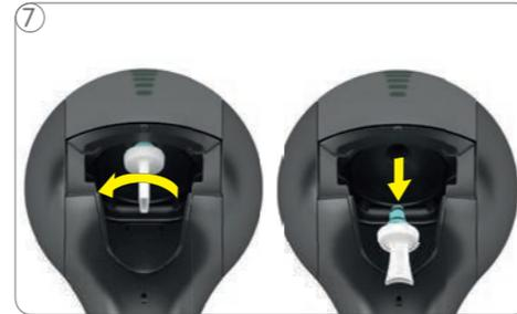
**Düse nur aus einer abgekühlten Maschine entfernen!** Düse-Werkzeug gegen den Uhrzeigersinn drehen. Düse entnehmen. **Düse nicht unbeaufsichtigt lassen! Düse darf nicht in die Hände von Kindern gelangen!**
