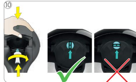
Düse von unten in die Öffnung der Maschine einführen. Düse mit der Hand abstützen. Düse im Uhrzeigersinn drehen, bis sie wieder fest in ihrer Position sitzt. Anweisungen in „8. ENTKALKUNG ZUMINDEST ALLE 3 - 4 MONATE“ auf Seite 13 befolgen.
