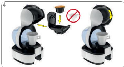
Kapselhalter öffnen. Sicherstellen, dass der Spülein satz nicht eingesetzt ist. Kapsel in den Kapselhalter stecken. Kapselhalter schließen. Kapselhalter wieder in die Maschine einführen. Arretierungsbügel schließen.
