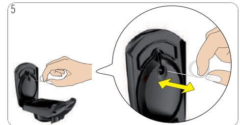
5 Kapselhalter öffnen und Düse mit Reinigungsnadel reinigen. Anweisungen in 8. „Entkalkung alle 3 – 4 Monate“ auf Seite 13 befolgen.
