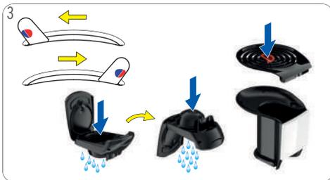
3 Maschine spülen: Anweisungen in 5. „ERSTE INBETRIEBNAHME“ auf Seite 8 befolgen. Kapselhalter auf beiden Seiten mit Spülmittel und Wasser reinigen. Abtropfschale mit Wasser abspülen und mit einer Bürste reinigen.
