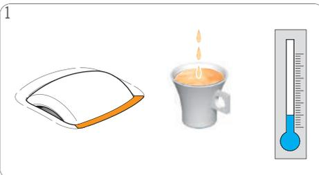
1 Wenn die Anzeigeleuchte von grün zu orange gewechselt hat (Entkalkungsanzeige) oder das Getränk langsamer als üblich herausläuft (evtl. sogar nur tropfenweise) oder kühler als üblich ist, muss die Maschine entkalkt werden.
